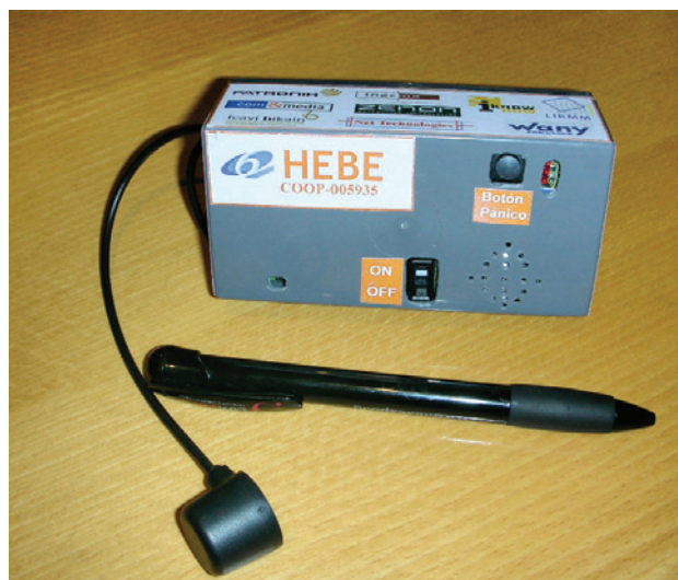
Figura 4. Prototipo del detector de caídas.
